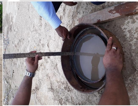
Figure 6.12 (d) Double ring infiltrometer test
