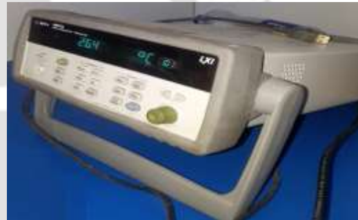
(d) Data acquisition system
