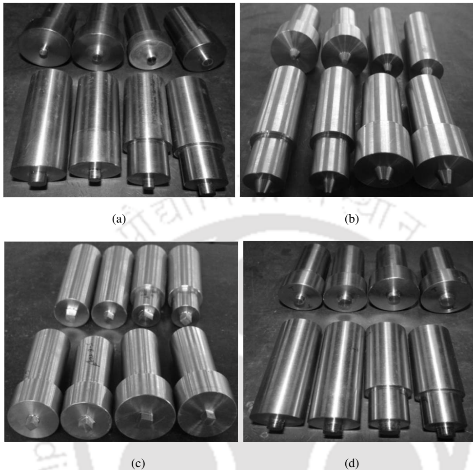
Figure 3.9 Fabricated tools (a) SC (b) TC (c) SQ and (d) THRD
