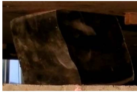
(d) at 40mm maximum displacement (45° loading direction)
