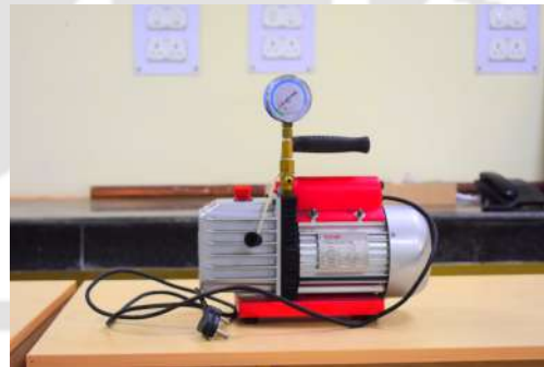
(d) TruVac make vacuum pump
