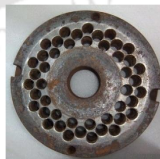
Fig. 4.31 Die plate of the Pellet press
