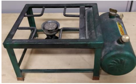
Fig. 6.7: BIS specified Roarer stove.
