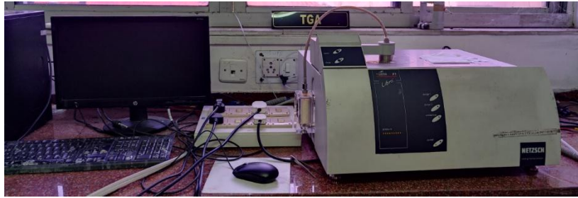
Fig. 4.4. Thermogravimetric analyser (Model No.: TG 209 F1 Libra; Make: M/s Netzsch, Germany)
