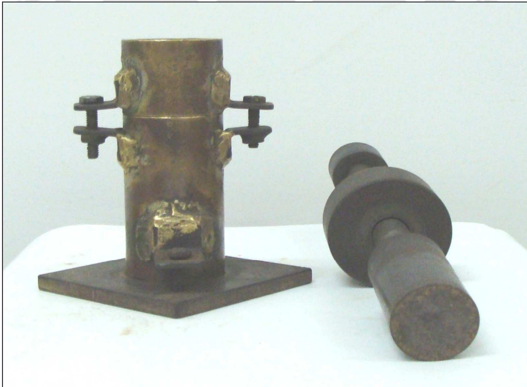
Fig. 3.12 Components of mini compaction apparatus
