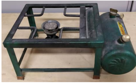
Fig. 6.7: BIS specified Roarer stove.
