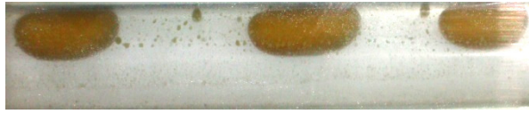
Fig. 4.1a Plug flow ( U_{SO}=0.082\text{m/s} ; U_{SW}=0.433\text{ m/s} ).
