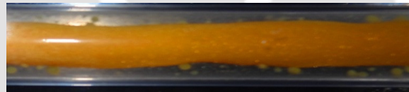
Fig. 4.1e Annular flow ( U_{SO}=0.45\text{m/s} ; U_{SW}=0.43\text{ m/s} ).
