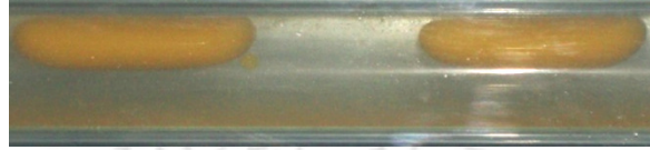
Fig. 4.1b Slug flow ( U_{SO}=0.04\text{m/s} ; U_{SW}=0.165\text{ m/s} ).
