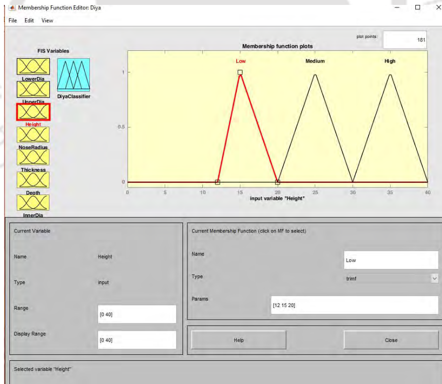
Fig.4.9: Membership function for height input parameter
